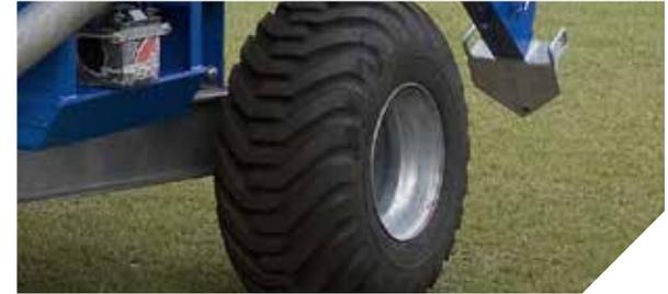
Nos modelos acima de 110 mm os pneus são individuais e de baixa compactação, evitando pneus de dupla rotação a Krebs garante menor manutenção das peças e também menor compactação do solo.
