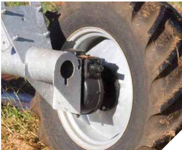
A Krebs utiliza redutores de roda com o padrão “trabalho pesado”. Muito robustos, são indicados para equipamentos que trabalham em situações de grande esforço. Nos pivôs rebocáveis operam com alavancas, o que permitem agilidade no deslocamento deste tipo de pivô.
