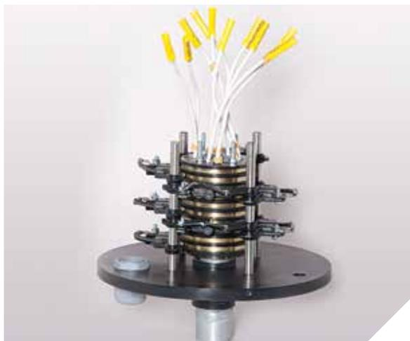
Montado sobre base plástica permite a montagem de até 13 pistas de anéis de cobre. As peças são injetadas em plástico e padronizadas, para evitar qualquer problema com falta de contato. São absolutamente simples em processos de manutenção/substituição, a ponto de serem usados em diversas outras marcas de pivôs.
