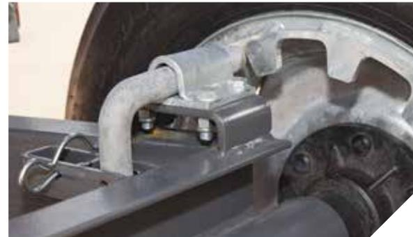
Todos os modelos têm freios por pino, com **sistema de fácil posicionamento**.
