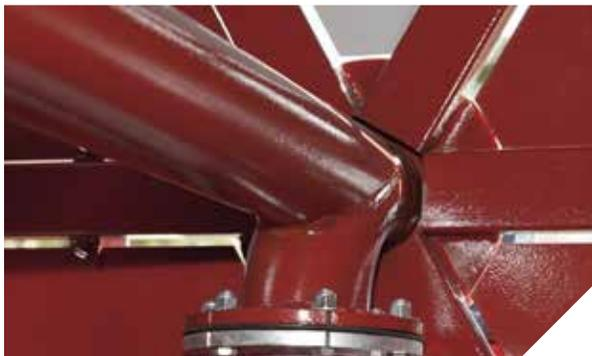
O "T" de entrada do equipamento é soldado, com isso há maior estruturação do carretel e auxilia a eliminação de vazamentos internos.
