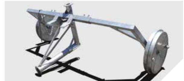
Nos modelos que usam água/dejetos o carro porta aspessor tem a estrutura 100% galvanizada a fogo. Tem pernas reguláveis para a adaptação a diversos tamanhos de canteiros/carreadores. As rodas são em aço com, ou sem ranhura e todas com contrapeso, que é usado para dar maior estabilidade durante a operação.
